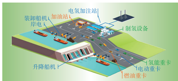
图1 水电站库区翻坝能源-物流耦合系统
