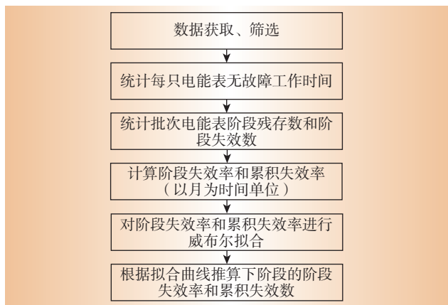
图5 基于威布尔分布的电能表整表寿命预测模型
