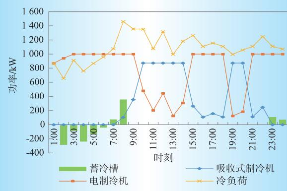
图3 CCHP系统冷负荷出力曲线
